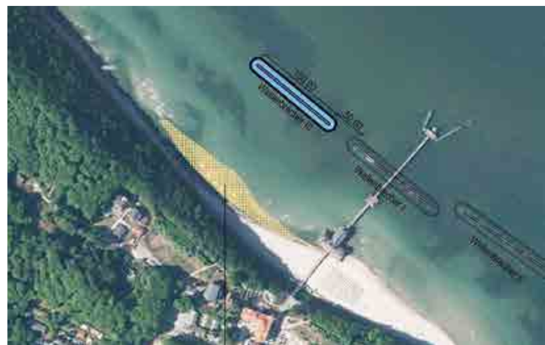
Abb.: Vorplanung dritter Wellenbrecher mit Initialaufspülung
